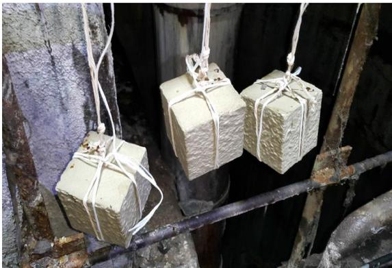
Испытания покрытия Эпоксипан (эпоксидный полидисперсный нанокompозит производства ООО «НПК Нанокompозит»
