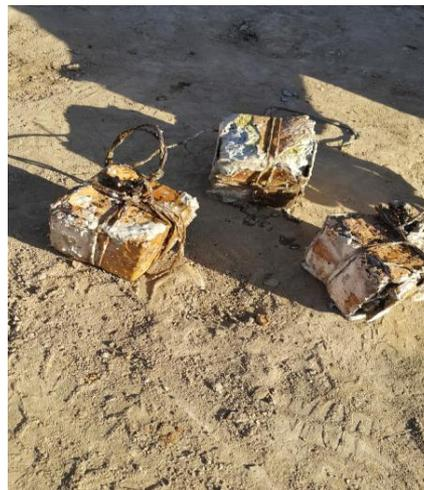
За период проведения испытаний 16.06.2015 г. – 24.03.2016г. покрытие разрушилось
